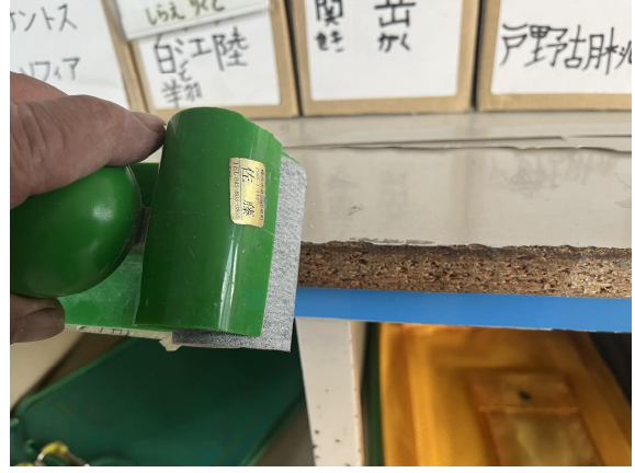
12日 ささくれがなくなり安全です。
