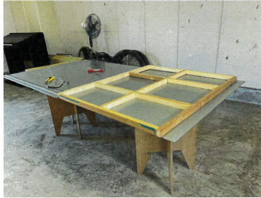
枠を組み立てる。ホッチキスで仮止め。
