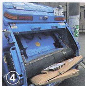
写真①② 段ボールを排出するときは、車両後部のテールゲート(積込装置)が上に大きく開き、奥の排出板がせり出し外に押し出します。
