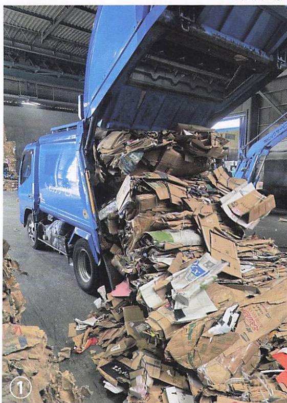
写真①② 段ボールを排出するときは、車両後部のテールゲート(積込装置)が上に大きく開き、奥の排出板がせり出し外に押し出します。
